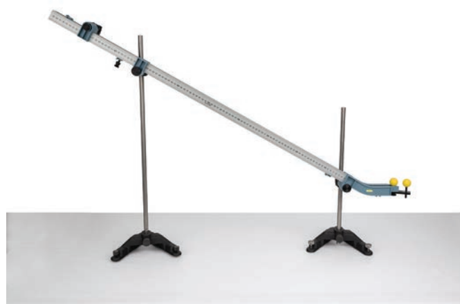
Use la rampa para lanzar la bola en horizontal desde una mesa y estudiar el movimiento de proyectiles. La bola baja por la rampa y choca con una segunda bola para estudiar la conservación del momentum en dos dimensiones.
