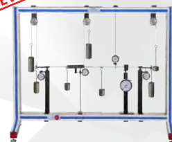
MDLE Equipo de Estudio de los Métodos para Determinar la Línea Elástica
