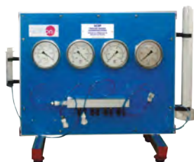
SCSP Sistema de Calibración de Sensores de Presión
