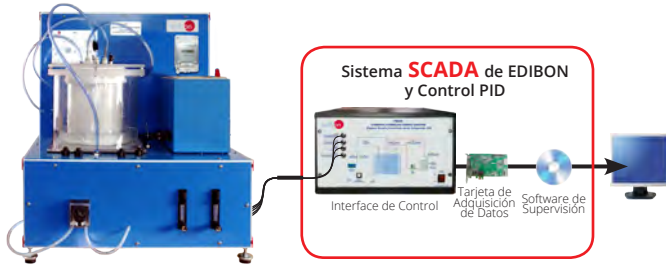
PDAC Digestor Aerobio, Controlado desde Computador (PC)
