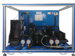
THALAC/1 Equipo para Control de Refrigeración, con varios Compresores, Controlado desde Computador (PC)
