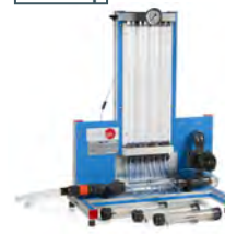
Equipo para el Estudio de Lechos Porosos en Tubos de Venturi (Ecuación de Darcy)
