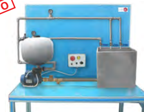
HSMAP Entrenador de sistema de suministro de agua mediante presión de aire
