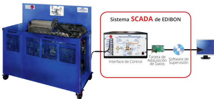
TMHC Banco de Ensayos para Motor Híbrido, Controlado desde Computador (PC)
