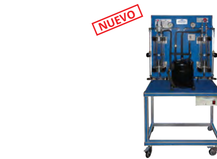
TSCR Equipo de Circuito de Refrigeración por Compresión Sencillo
