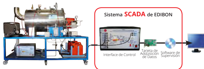
TVCC Equipo de Combustión de Laboratorio, Controlado desde Computador (PC)
