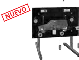
MFF Equipo de Fuerza de Frenado y Aceleración
