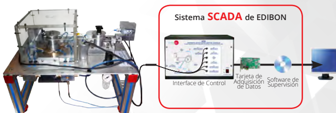
HTIC Turbina Experimental de Impulsión, Controlada desde Computador (PC)
