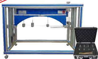
MFCS3 Equipo para Estudio de Deformación en Celosías
