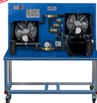
TCRCT Equipo de Refrigeración por Compresión con Distintos Tubos Capilares
