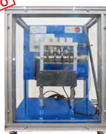
MDFC Equipo para Demostración de la Fuerza de Coriolis
