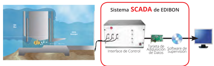
ETMC Equipo de Energía Térmica Oceánica, Controlado desde Computador (PC)
