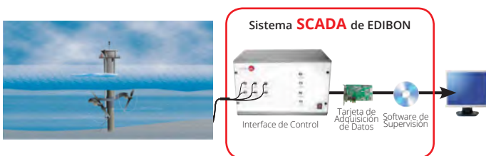
ECMC Equipo de Energía por Corrientes Submarinas, Controlado desde Computador (PC)
