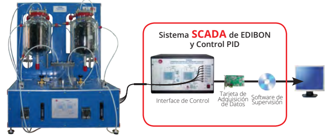
PDANC Digestor Anaerobio, Controlado desde Computador (PC)
