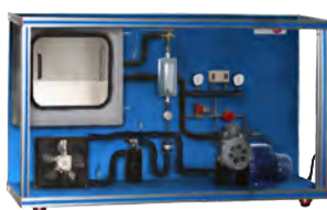
TRCC Equipo de Refrigeración con Compresor Abierto, Controlado desde Computador (PC)
