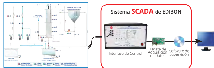
PPBC Equipo de Procesos de Biopelícula, Controlado desde Computador (PC)
