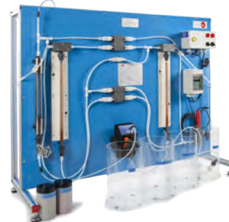
EII Equipo de Intercambio Iónico
