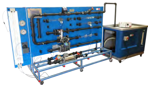
FMDU Equipo de Demostración de Medidores de Caudal
