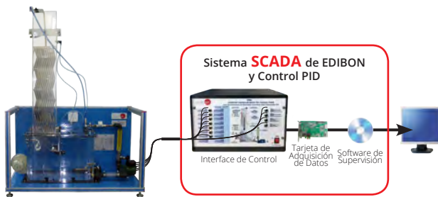
TTEC Torre de Enfriamiento de Sobremesa, Controlada desde Computador (PC)
