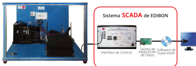
TPCC Congelador de Placa de Contacto, Controlado desde Computador (PC)
