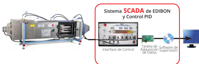
SBANC Secador de Bandejas, Controlado desde Computador (PC)
