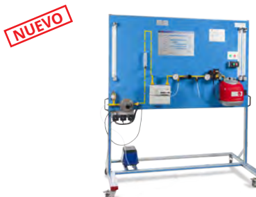
GBT Equipo de Experimentación con Quemador de Gas de Tiro Forzado
