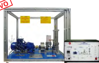
MED Equipo de Equilibrio Dinámico/Estático
