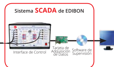
TRCVC Equipo de Refrigeración por Compresión de Vapor, Controlado desde Computador (PC)
