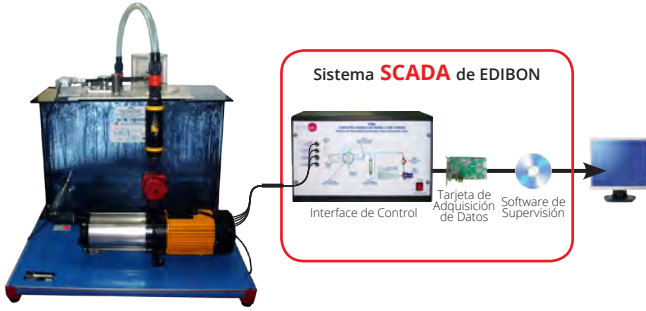
TFRC Turbina de Flujo Radial, Controlada desde Computador (PC)
