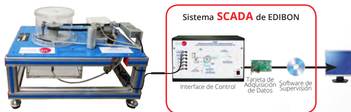
HTRC Turbina Experimental de Reacción, Controlada desde Computador (PC)
