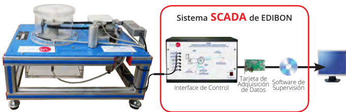
HTRC Turbina Experimental de Reacción, Controlada desde Computador (PC)
