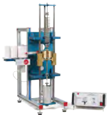
MVL Equipo de Vibraciones Libres
