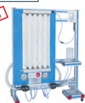
Equipo de Venturi, Bernoulli y Cavitación
