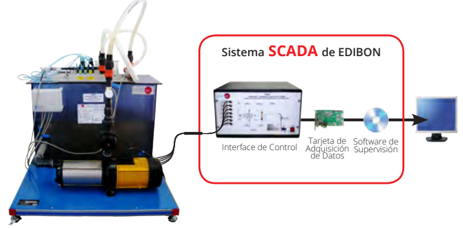
HTIC Turbina Experimental de Impulsión, Controlada desde Computador (PC)
