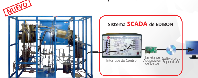
QEDC Equipo de Extracción de Disolvente en Discontinuo, Controlado desde Computador (PC)
