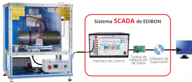
TGFAC Turbina de Gas de Flujo Axial/ Motor de Reacción, Controlada desde Computador (PC)
