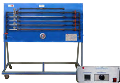
TEV3V Equipo de Entrenamiento de Válvula Mezcladora de 3 vías
